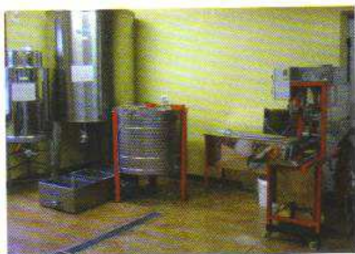
Interno del capannone in bioedilizia, con le principali attrezzature per l'estrazione del miele. Gli intonaci a calce sono ricoperti da uno strato di cera d'api. (Foto di A. Dettori)
